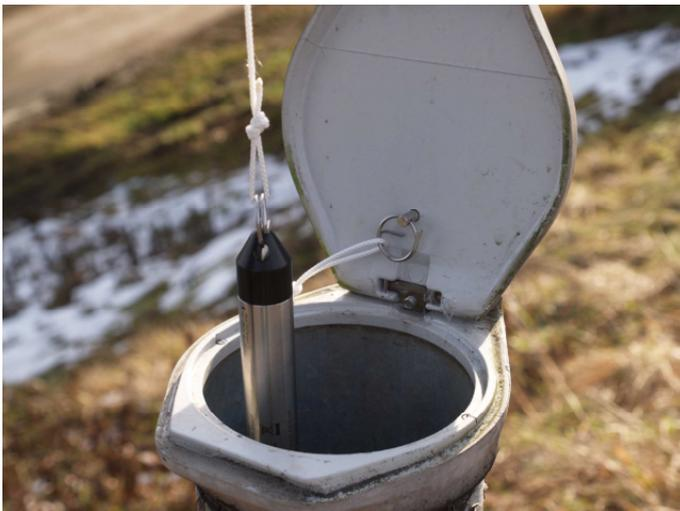
**Foto 5:** *Grundwasserüberwachung: Grundwasserbeobachtungsstelle mit eingebauter, automatischer Sonde für die kontinuierliche Aufzeichnung von Wasserstand, Temperatur und elektrischer Leitfähigkeit.*
