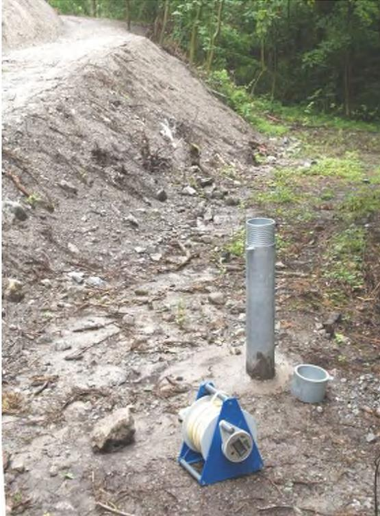
**Foto 4:** Grundwasserüberwachung: Typische Ausführung einer Grundwasserbeobachtungsstelle für die Messung des Wasserspiegels, Probenahme usw.
