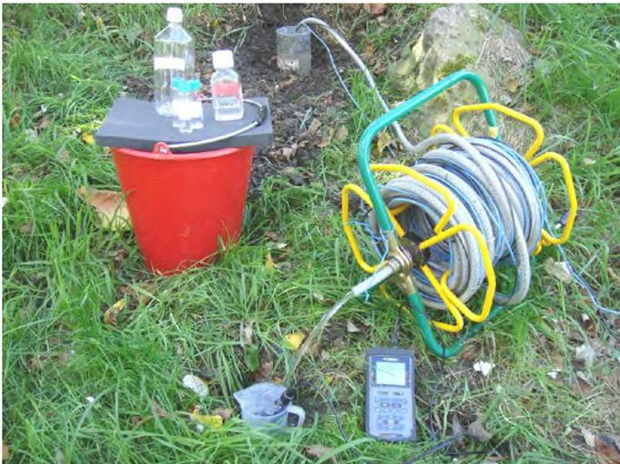
**Foto 7:** *Grundwasserüberwachung: Probenahme aus Grundwasserbeobachtungsstelle anhand einer mobilen Pumpe zur Untersuchung der Grundwasserbeschaffenheit (ehemalige Deponie Rheinau, Vaduz, 2009).*
