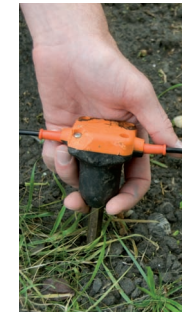
Die Geophone werden entlang der Messlinie ausgelegt.
