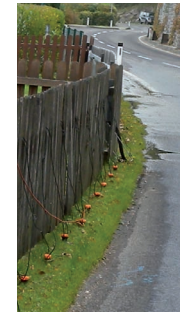
Die Geophone werden entlang der Messlinie ausgelegt.
