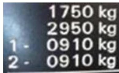
Somit ist das mögliche Gewicht des Zuges von 3050kg (Volle Beladung Auto und Anhänger) grösser als das vom Hersteller erlaubte Gewicht des Zuges von 2950kg.
